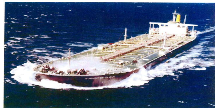
四十四萬五千載重噸超級大油輪 船名：柏瑪奮進號 船主：美國惠固公司 船類：油輪 船長：177.2公尺 船寬：68公尺 船深：31.6公尺 吃水：25公尺 載重：44,500 DWT 建造日期：1977年12月15日 交付日期：1977年12月15日 船主：BURMAH OIL CO. LTD. 船類：OIL TANKER 船長：177.2 M 船寬：68 M 船深：31.6 M 吃水：25 M 載重：44,500 DWT 建造日期：1977年12月15日 交付日期：1977年12月15日
